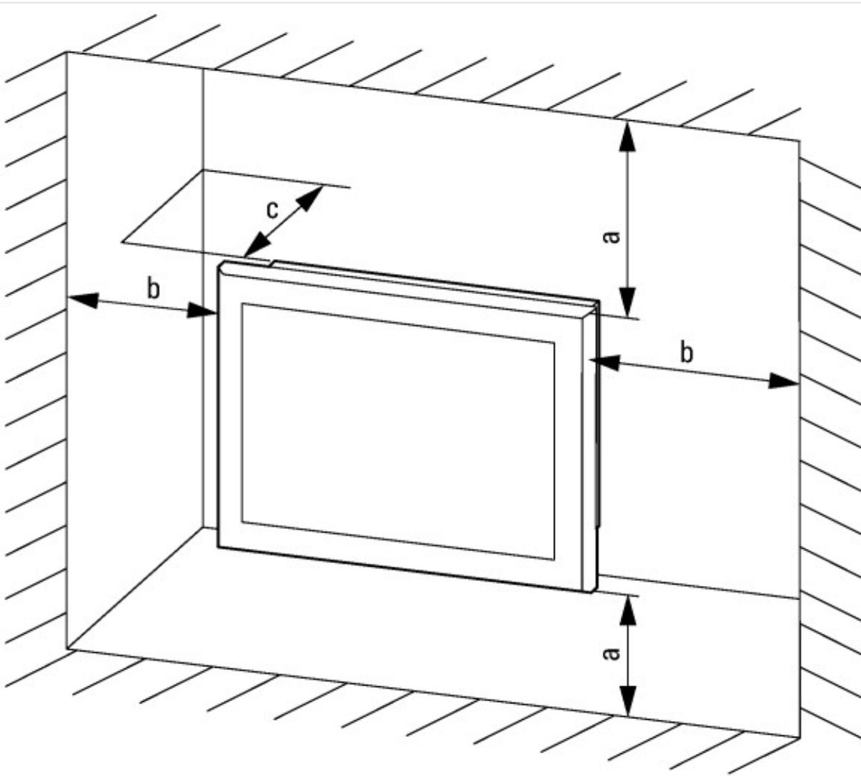
$a, b, c \geq 30 \text{ mm}, 90 \leq T \leq 50 \text{ }^\circ\text{C}$
