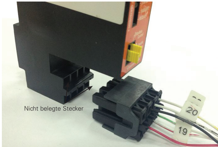
Abbildung 4. Anschaltung an das CAM-Modul.
