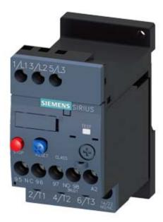
OVERLOAD RELAY 0.14...0.20 A FOR MOTOR PROTECTION SZ S00, CLASS 10, STAND-ALONE INSTALLATION MAIN CIRCUIT: SCREW TERMINAL AUX. CIRCUIT: SCREW TERMINAL MANUAL-AUTOMATIC-RESET
