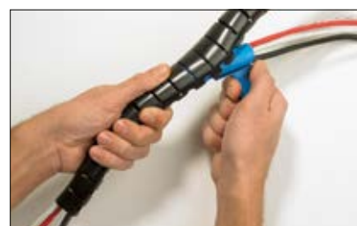
Trekk deretter verktøyet gjennom Helawrap.
