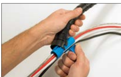
Plasser verktøyet i den ene enden av Helawrap kabelbeskyttelse.
