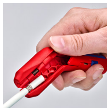
Stripping av en koax-kabel
