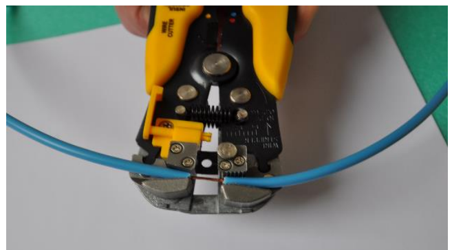
Figur 4.4 Avisolering av RKK med avisoleringstang
