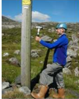
Testing med hammer
