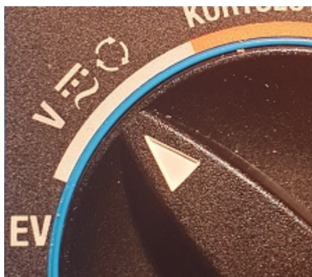
Figur 6.4.1 Rotasjonsbryter og skjerm for spenningsmåling ved oppstart
