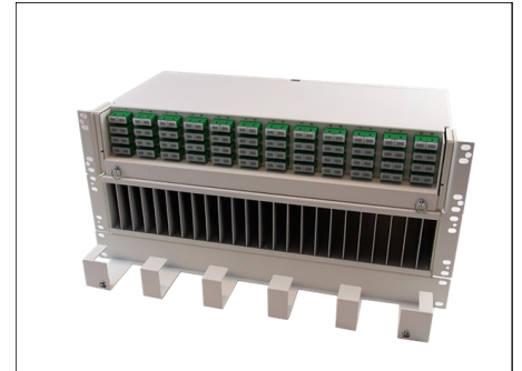
2U panel med underliggende 2U lagringsenhet og 1U kabelrenne. Totalt 5U
