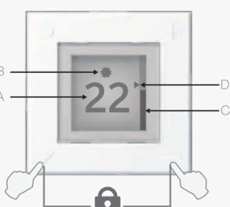
Tastelås av/på: trykk og hold **✓** og **-** i 5 sekunder. Keylock on/off: press and hold **✓** and **-** for 5 seconds
