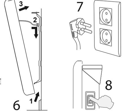
(S) Radiatorer för fast installation skall föregås av allpolig brytare med minst 3mm fränskiljnings avstånd samt installeras i enlighet med nationella föreskrifter och lokala bestämmelser.
