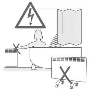
(S) Varning! Vissa delar av denna produkt kan bli mycket varma och orsaka brännskador. Ha alltid uppsikt över små barn eller personer som inte har förmåga att hantera elementet på rätt sätt. Se till att berörda personer får lära sig att hantera elementet. Se till att barn inte leker med apparaten.
